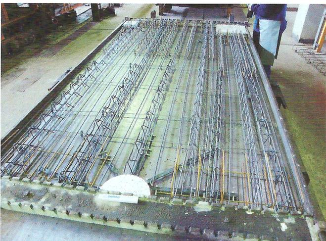
Ein Bewehrungsroboter bringt die notwendige Bewehrung und Gitterträger ein. Da keine Bolzen herausstehen, lässt sich die Verlegung reibungslos durchführen.
